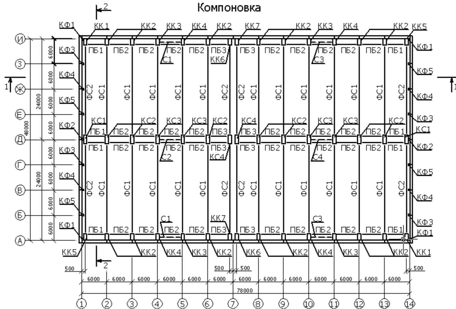
Рисунок 1.1 - Схема расположения элементов каркаса
